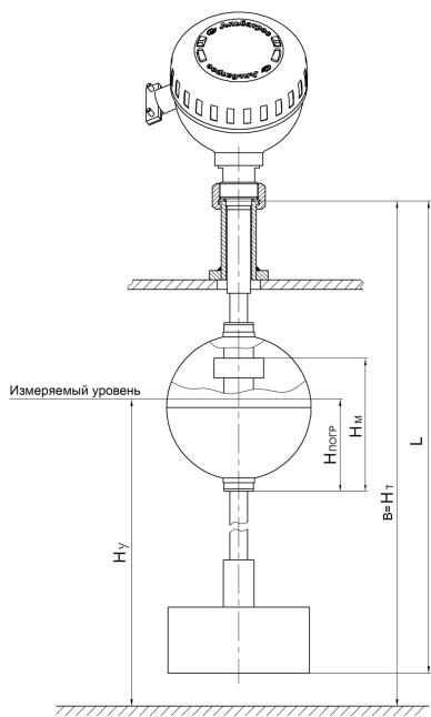
Рисунок 6 – Схема определения уровня срабатывания прибора
