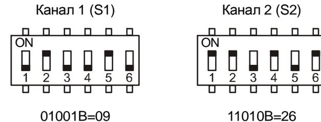
Рисунок 7 – Положение секций переключателей для рассматриваемого примера
