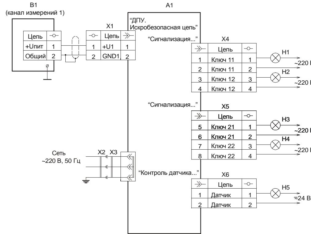
**A1** - преобразователь вторичный сигнализатора ПВС8 УНКР.436611.004-01 ;
