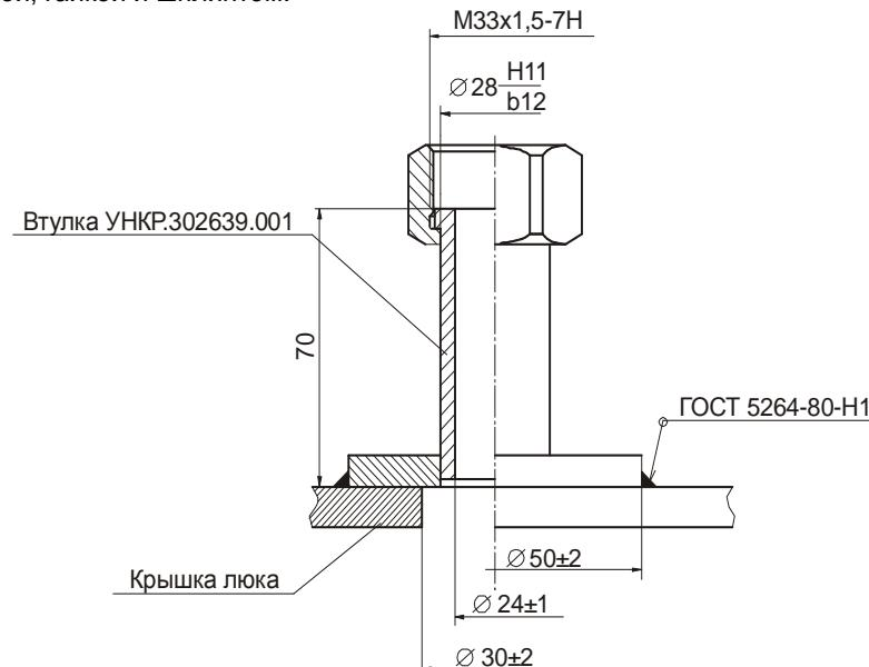
Рисунок 2 – Рекомендуемое посадочное место для установки датчика
