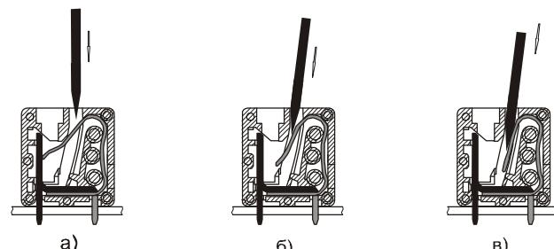
Рисунок 4 – Последовательность заглубления отвёртки
