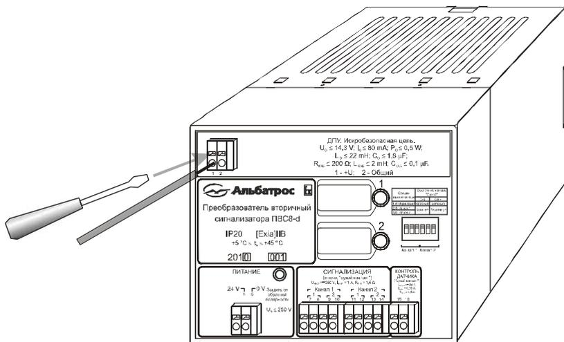
Рисунок 3 – Подключение электрических цепей к прибору
