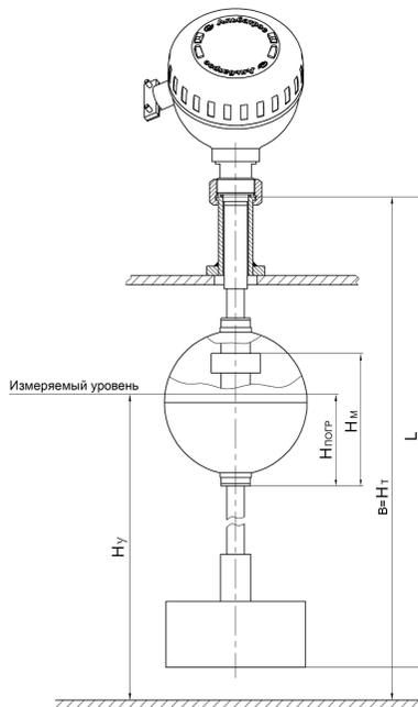
Рисунок 6 – Схема определения уровня срабатывания прибора
